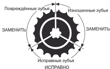
Рисунок 2. Износ звезд
