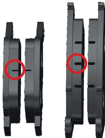
Фото 5.10. Определение износа тормозных колодок
