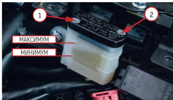
Фото 5.8.1. Бачок тормозной жидкости задних тормозов: 1 – крышка бачка;
