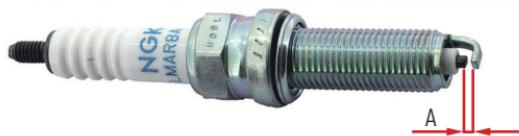
Фото 5.3. Зазор «A» между электродами свечи зажигания
