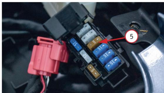
Фото 4. Аккумуляторный отсек и блок предохранителей: 1 – клемма «минус»; 2 – ремень крепления аккумуляторной батареи (АКБ); 3 – аккумуляторная батарея; 4 – колпачок клеммы «плюс»; 5 – блок предохранителей
