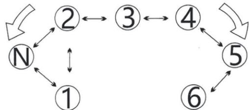
Рисунок 1. Схема переключения передач
