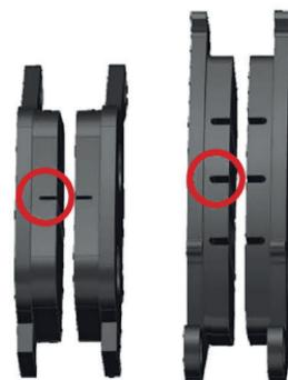
Фото 5.9. Определение износа тормозных колодок
