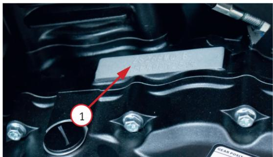
Фото 1.1. Справа на двигателе нанесен серийный номер двигателя - 1
