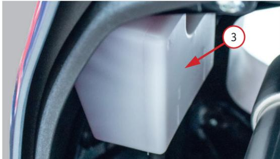
*Фото 5.7.1. Бачок охлаждающей жидкости 3*
