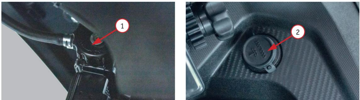
Фото 5.7. Замена охлаждающей жидкости: 1 – крышка радиатора; 2 – крышка бачка
