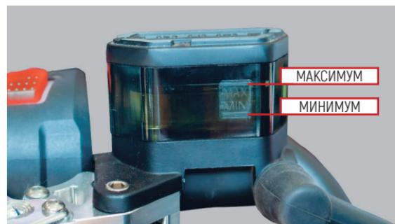
Фото 5.8.2. Бачок тормозной жидкости передних тормозов
