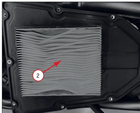
*Фото 5.1. Снятие воздушного фильтра: 1 – крышка отсека воздушного фильтра;
