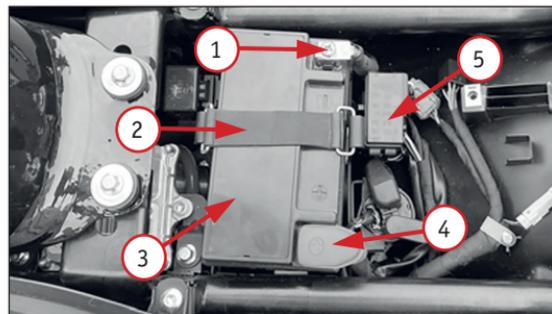
*Фото 4. Аккумуляторный отсек: 1 – клемма «минус»; 2 – ремень крепления аккумуляторной батареи; 3 – аккумуляторная батарея (АКБ); 4 – колпачок клеммы «плюс»; 5 – блок предохранителей*
