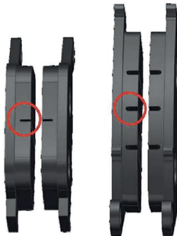
Фото 5.9. Определение износа тормозных колодок
