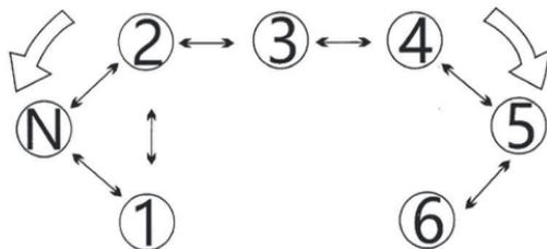
Рисунок 1. Схема переключения передач
