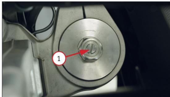
*Фото 2.13. Регулировка демпфирования передних и заднего амортизаторов: регулировочный винт 1*
