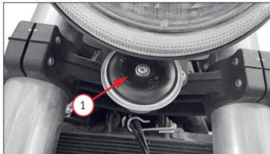
Фото 4.1. 1 - Регулировочный винт электрического звукового сигнала
