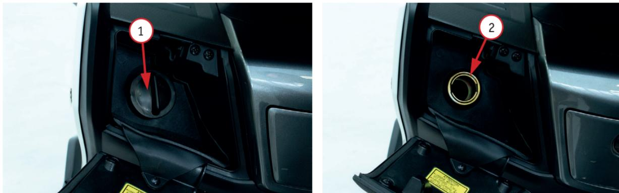
Фото 2.6. Топливный бак: 1 – крышка бензобака; 2 – горловина бака
