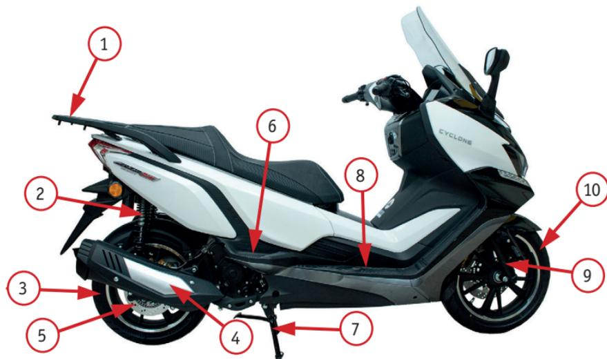
Фото 2.2. Вид скутера справа: 1 – задняя грузовая полка; 2 – задний амортизатор; 3 – заднее колесо; 4 – глушитель; 5 – задний дисковый тормоз; 6 – задняя правая подножка для пассажира; 7 – центральная подставка; 8 – правая передняя площадка для ноги водителя; 9 – правый передний амортизатор; 10 – переднее колесо
