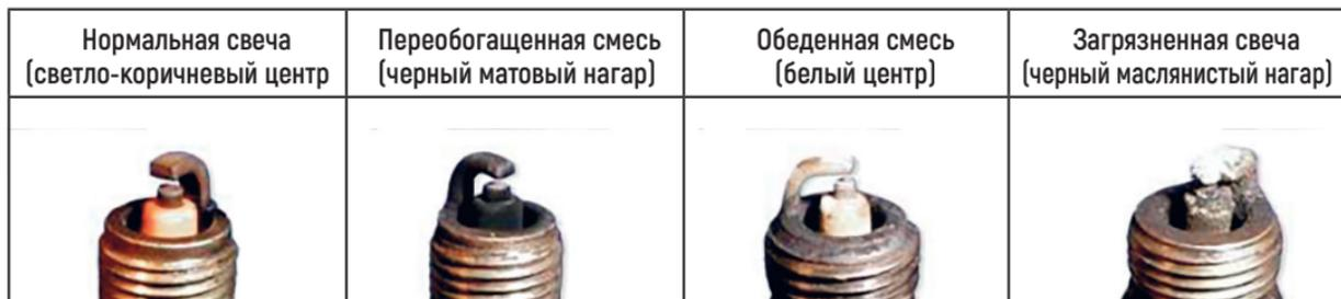
*Фото 5.9. Состояния свечи зажигания*
