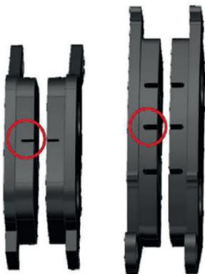
*Фото 5.9. Определение износа тормозных колодок*
