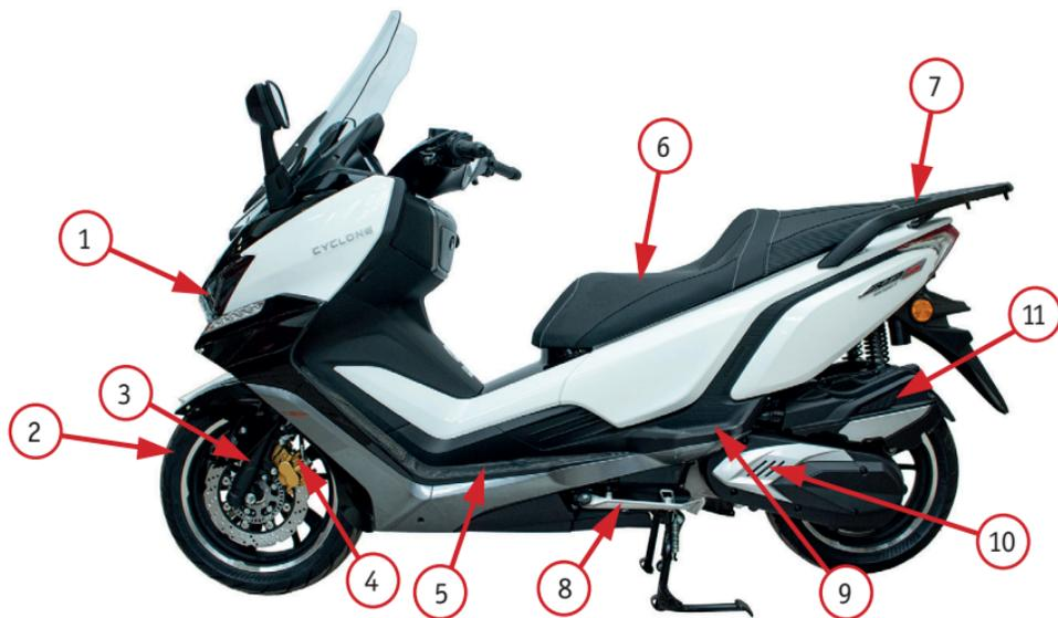
Фото 2.3. Вид скутера слева: 1 – передняя фара; 2 – переднее колесо; 3 – передний левый амортизатор; 4 – передний тормозной суппорт; 5 – левая передняя площадка для ноги водителя; 6 – сиденье; 7 – поручень пассажира; 8 – боковая подставка; 9 – левая задняя подножка для пассажира; 10 – двигатель; 11 – воздушный фильтр
