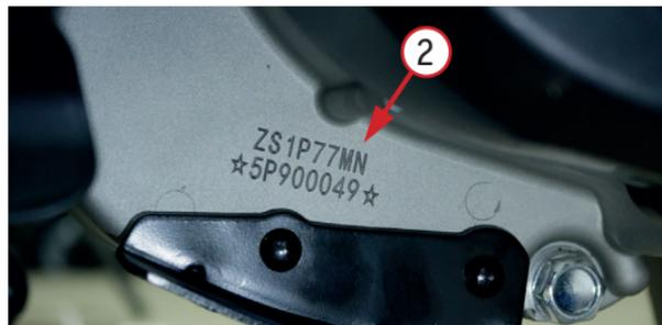
Фото 1.2. Заводской номер двигателя 2 нанесен слева на картере
