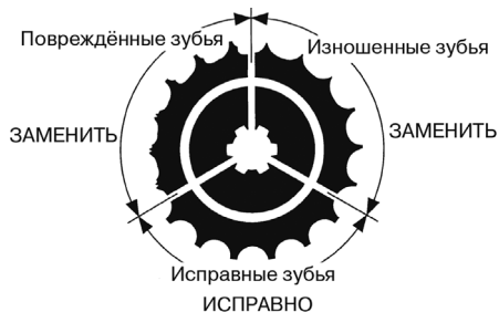
Рисунок 2. Износ звезд
