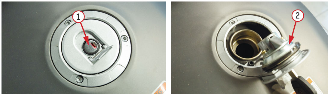
Фото 2.6. Топливный бак: 1 – крышка бака закрыта; 2 – крышка бака открыта
