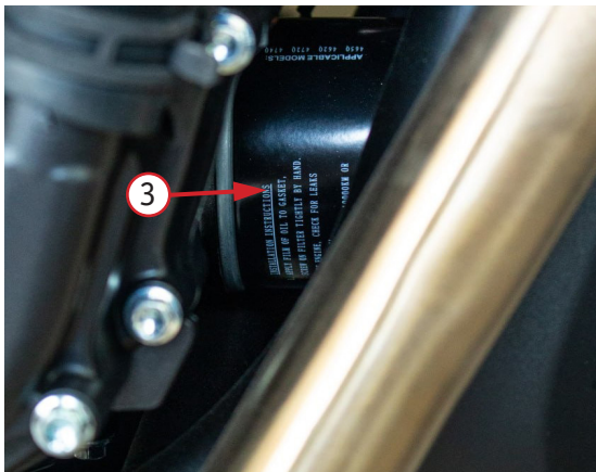
Фото 5.6. Замена масляного фильтра 3
