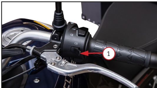
Фото 2.3. Левый комбинированный переключатель (вид спереди): 1 – кнопка включения дальнего света при обгоне
