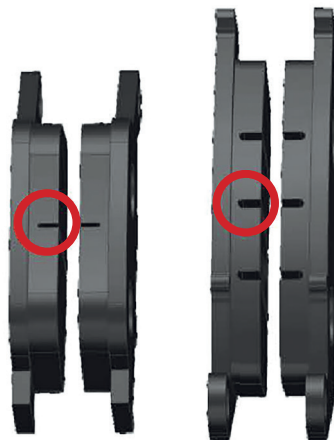
Фото 5.10. Определение износа тормозных колодок
