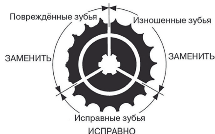
Рисунок 2. Износ звезд
