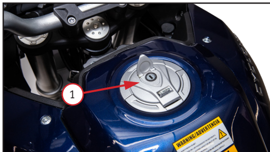
Фото 2.6. Топливный бак: 1 – замочная скважина на крышке; 2 – крышка бака открыта
